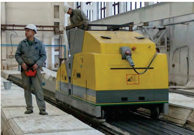
Bild 25: Extruderfertigung von Spannbetonhohlplatten
