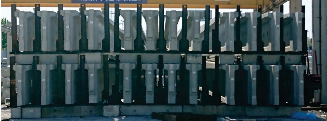
Bild 27: Spannbetonbinder auf dem Lagerplatz
