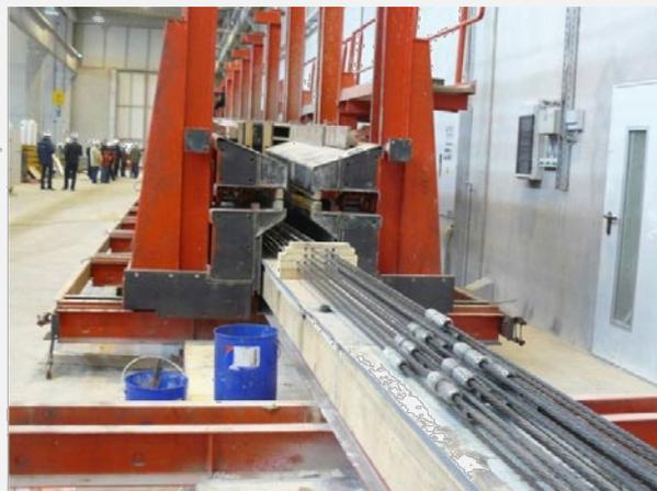
Bild 1: Systemschalungen für TT-Platten und für I-Binder
