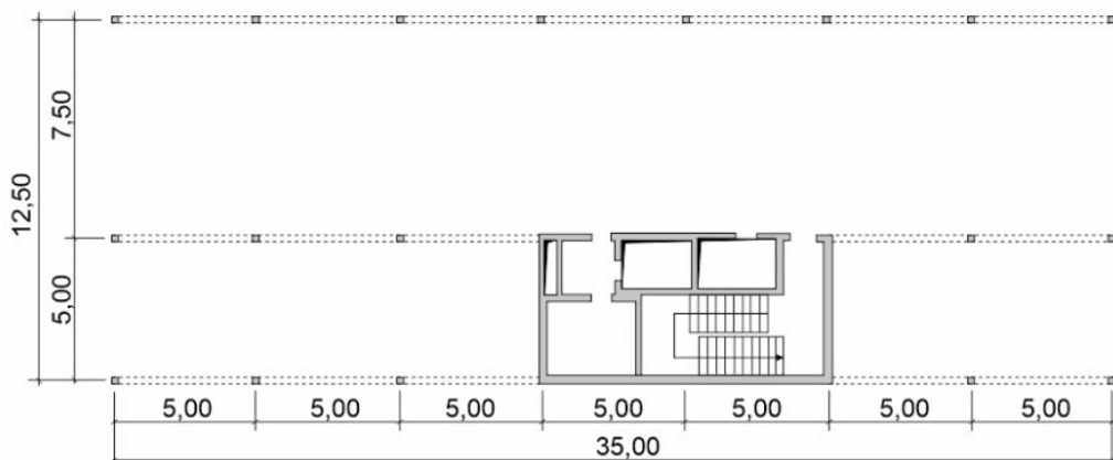
Bild 1: Grundriss des Mustergebäudes
