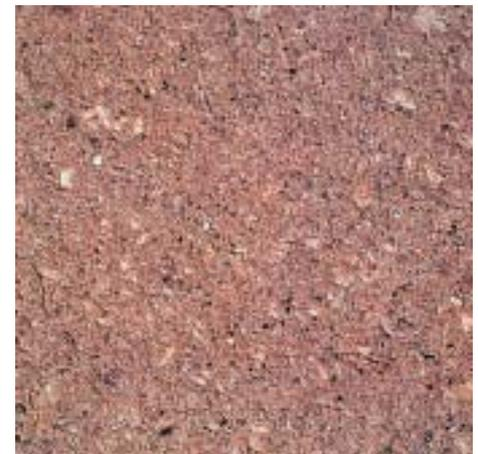
Bild 7.6: Feingewaschene Betonoberfläche, Rheinsand und Porphyrt 0-16 mm, weißer Zement, 1 % Eisenoxidrot
