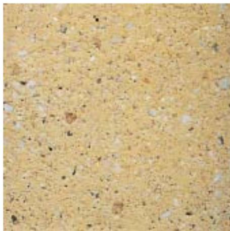
Bild 7.7: Gestrahlte Betonoberfläche, Singhofener Quarz 0-16 mm, weißer Zement, 0,2 % Eisenoxidgelb
