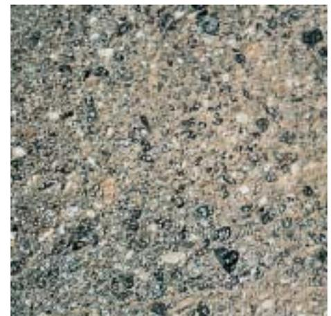
Bild 7.8: Gestockte Betonoberfläche, heller und dunkler Zuschlag, grauer Zement
