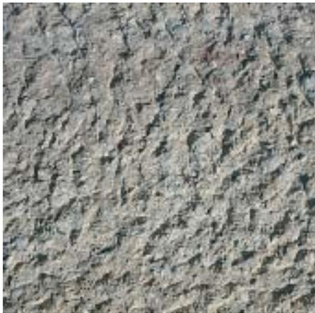
Bild 7.9: Gespitzte Betonoberfläche, Rheinkies, grauer Zement
