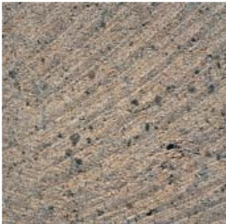
Bild 7.12: Gesägte Betonoberfläche, eingefärbt, weißer Zement
