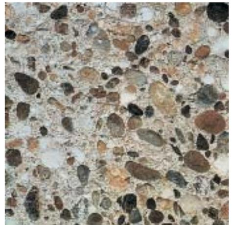
Bild 7.17: Flammgestrahlte Betonoberfläche, Rheinkies 0-16 mm, weißer Zement, 3 % Titandioxid
