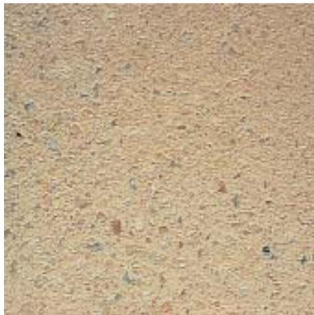
Bild 7.16: Abgesäuerte Betonoberfläche, heller Zuschlag, weißer Zement, 0,2 % Eisenoxidgelb
