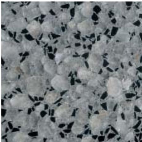
Bild 7.15: Polierte Betonoberfläche, heller und dunkler Zuschlag, weißer Zement
