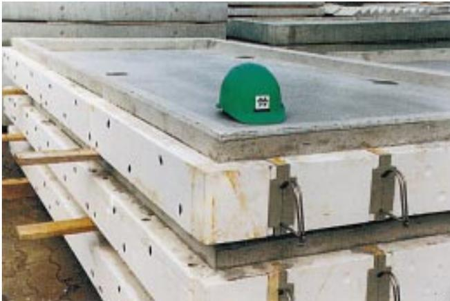
Im Negativverfahren hergestellte Loggiaplatten mit thermischer Trennung vor dem Einbau
