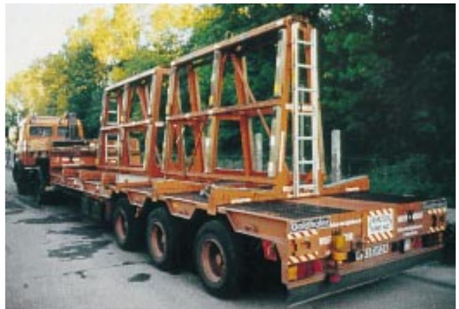
Sattelanhänger mit A-Bock für den Fassadentransport
