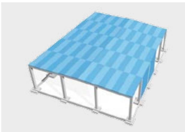
Bild 2.21: Aussteifung durch Dach- und Wandscheiben
