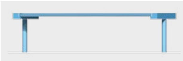
Bild 2.7: Spannbeton-Hohlplatten ohne Mittelunterstützung
