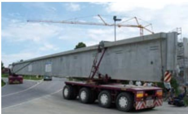
Bild 1.8: Zugmaschine mit Nachläufer
