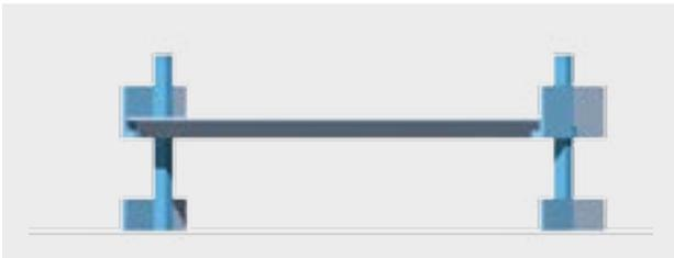
Bild 2.8: TT-Platten ohne Mittelunterstützung
